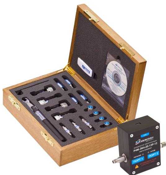
В программном обеспечении анализатора предусмотрены однопортовая, полная двухпортовая, однопортовая двухпортовая калибровки, нормализация частотной характеристики тракта передачи или отражения. Калибровка анализатора может осуществляться с использованием наборов мер или с помощью электронных калибраторов.
