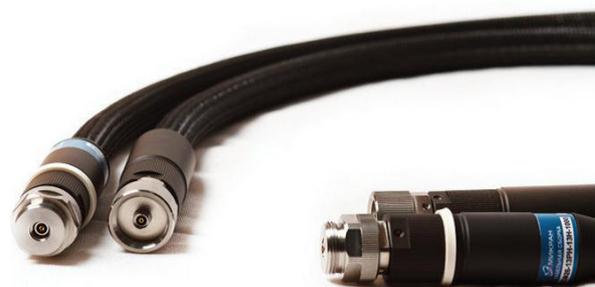
**Для повышения фазовой стабильности кабельные СВЧ сборки изготовлены со специальной защитой и соединителями усиленного типа NMD.** Защита ограничивает минимальный радиус сгибания кабеля, защищает кабель от сдавливания, продольных нагрузок и поперечного скручивания, что повышает ресурс кабеля до нескольких сотен тысяч сгибаний со стабильной фазовой характеристикой.
