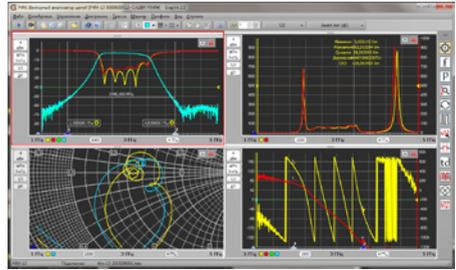
Векторные анализаторы цепей P4213/P4226 построены по архитектуре виртуальных приборов. Данная архитектура позволяет увеличивать функциональность прибора за счёт большого выбора программных опций.
