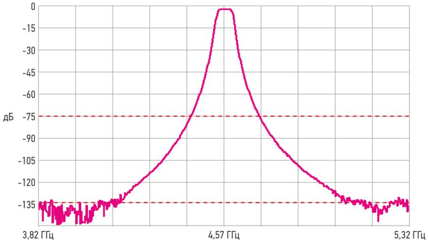
Зашумленность трассы при измерение S11, фильтре ПЧ 1 кГц, выходная мощность 0 дБм
