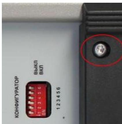
Рисунок 3 – Схема пломбировки от несанкционированного доступа (выделено).
