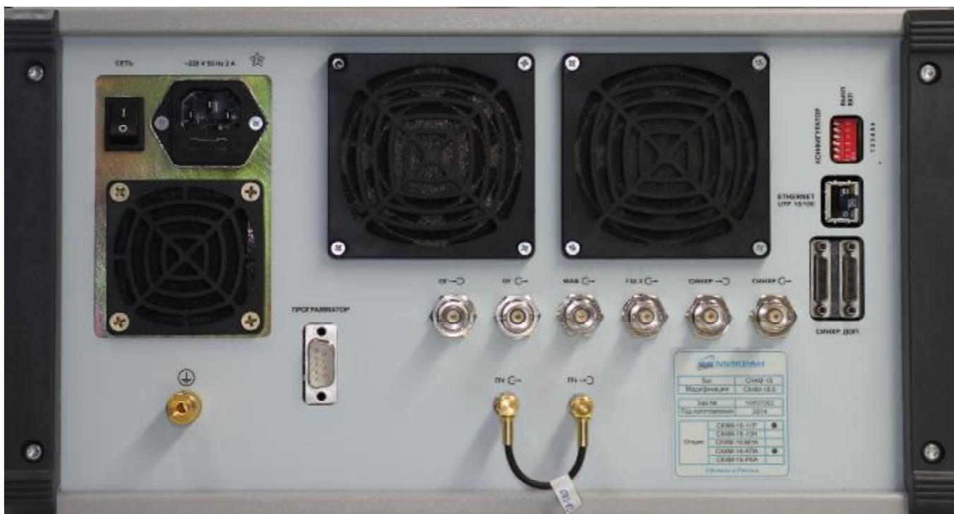
Рисунок 2 – Внешний вид анализатора спектра (задняя панель).
