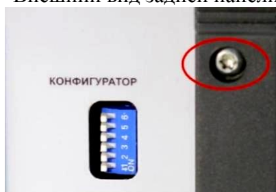
Рисунок 3 – Схема пломбировки от несанкционированного доступа (выделено овалом)
