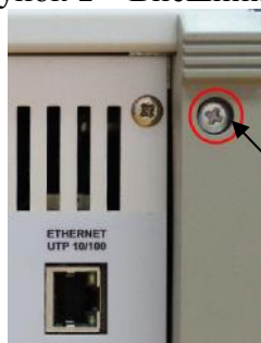
Рисунок 2 – Место на задней панели для пломбирования
