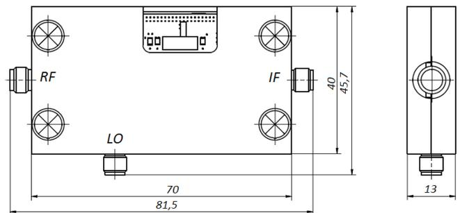
Конвертер КВ-3545/1 состоит из широкополосного высокочастотного смесителя с функцией подавления зеркального канала приема, на входе у которого включен МШУ. Частоты сигнала гетеродина диапазона 17,5...22,5 ГГц умножаются на встроенном умножителе частот. Для достижения оптимальных характеристик мощность гетеродина должна быть равна 0 дБм, частота гетеродина (после умножения) должна быть больше частоты входного сигнала. Питание на блок можно подать двумя способами:
