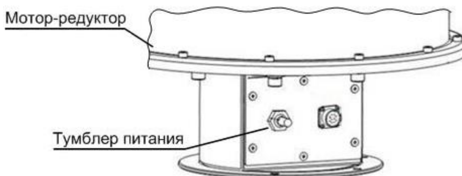
Рисунок 10 – Расположение тумблера питания на УПП
