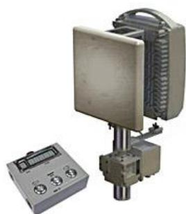
Антенное устройство панельного типа может комплектоваться антенно-поворотным устройством АПУ-1К с возможностью электронной дистанционной юстировки по азимуту (угол-места устанавливается фиксированно, погрешность наведения по углу-места компенсируется широкой диаграммой направленности антенны).
