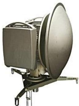
Антенное устройство зеркального типа может комплектоваться опорно-поворотным устройством с возможностью ручной дистанционной юстировки по азимуту и углу-места для установки на телескопические мачты (юстировка по азимуту осуществляется вращением мачты, точность наведения обеспечивается применением антикрутильного яруса).
